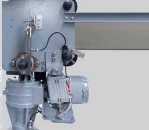
Struttura interamente zincata a caldo con verniciatura protettiva.
